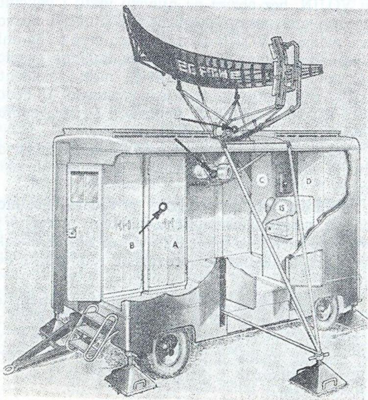
Sl. 130. Uništavanje primopredajne kabine i antenskog sistema
